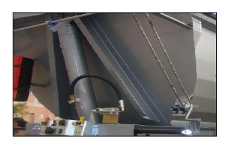
Detalle del cilindro hidráulico válvula de tarado
