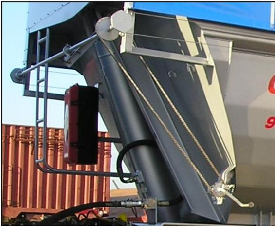
Detalle sistema de accionamiento de toldo manual
