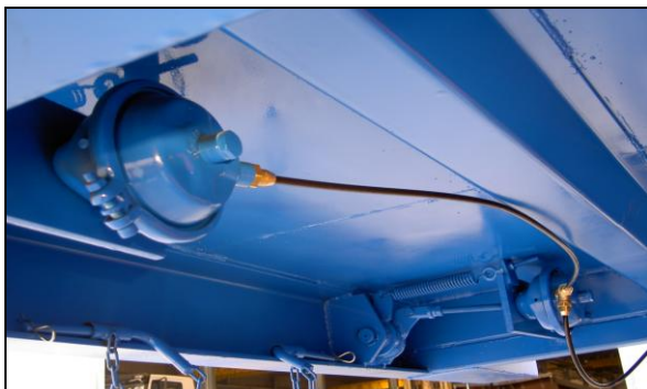
Detalle de cierre neumático mediante pulmones
