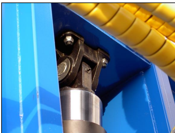
Detalle cogida superior de cilindro hidráulico
