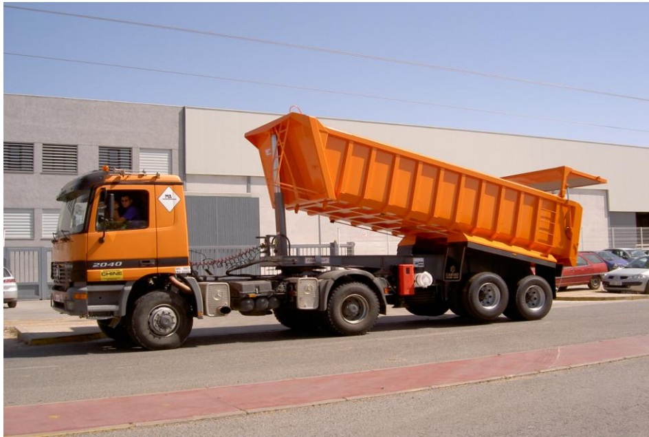
Semirremolque volquete 2 ejes neumático doble con puerta hidráulica
