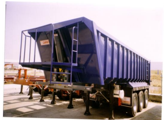
Pasarela delantera para acceso a zona frontal
