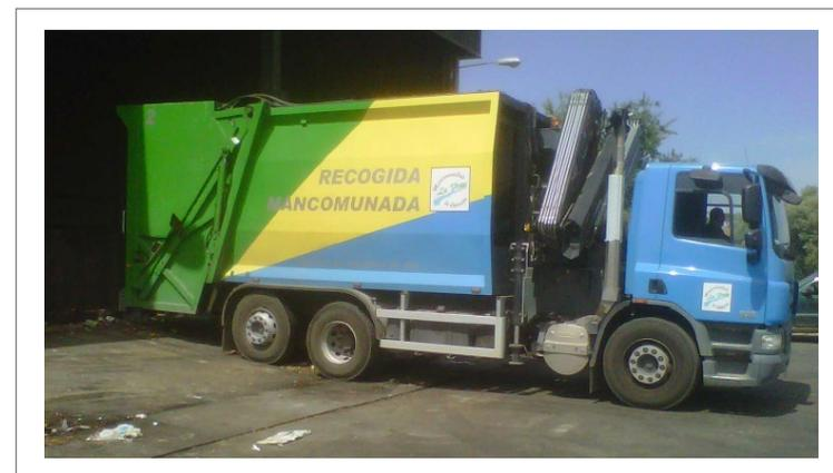
Camión de 3 ejes carrozado con caja PV4 y Grúa
