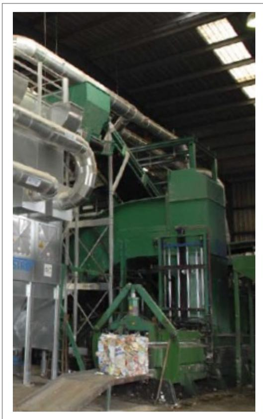
Prensadora para la fabricación de cubos compactados de papel y cartón
