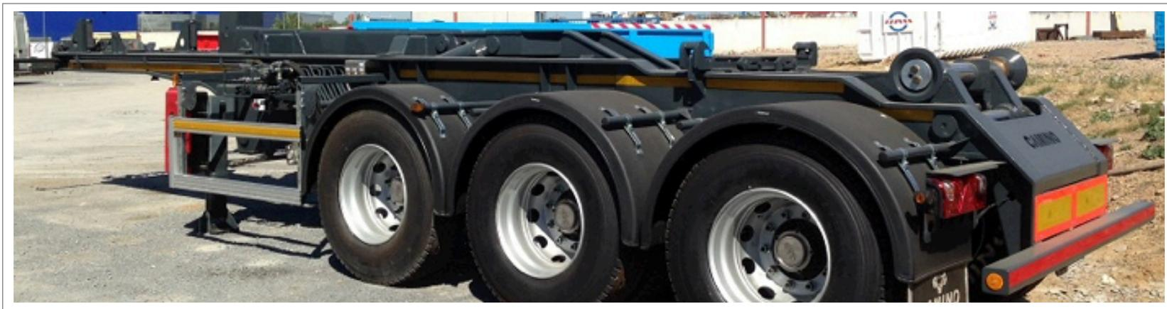
Semiremolque con equipo multi-basculante para transporte de compactadores y cajas de residuos de gran volumen
