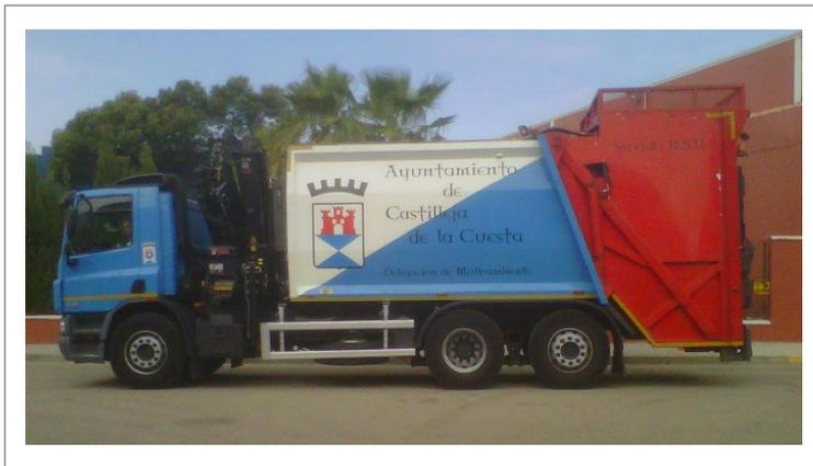
Camión Marca Daf carrozado con caja recolectora modelo PV4 con Grúa
