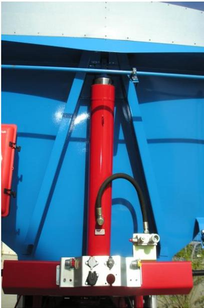
Detalle de cilindro hidráulico
