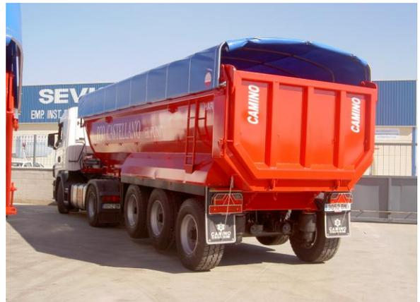
Guardabarros de una sola pieza de chapa y trasera poligonal
