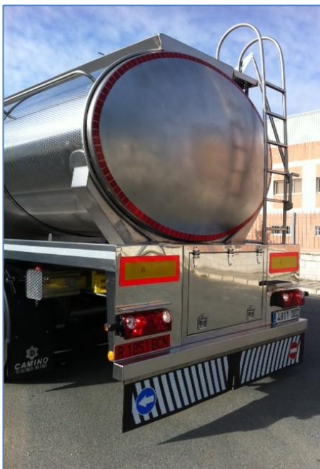
Vista trasera cisterna con caja de apertura para final de colector
