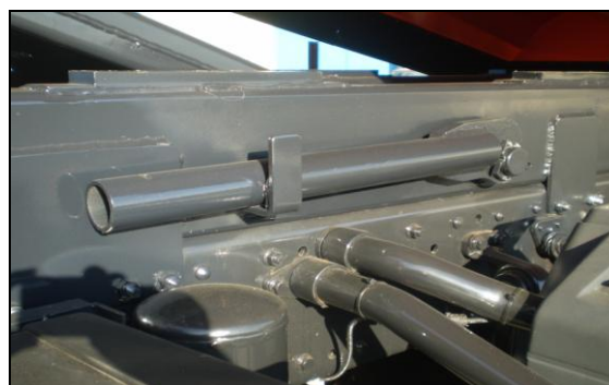
Tentemozo para operaciones de mantenimiento
