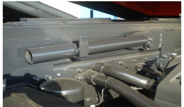
Tentemozo para operaciones de mantenimiento
