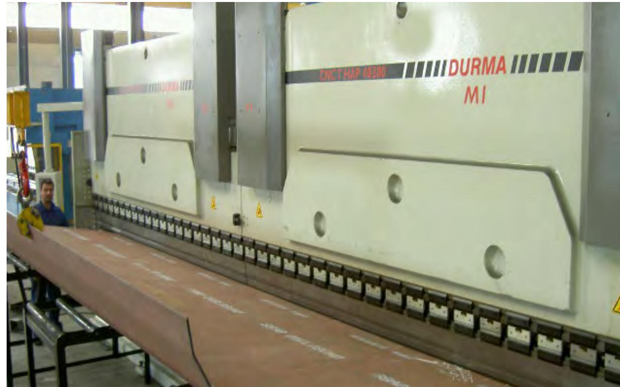
Plegado de chapa antidesgaste 450 brinell de dureza de 10 mm de espesor de 8.000 x 2500 mm
