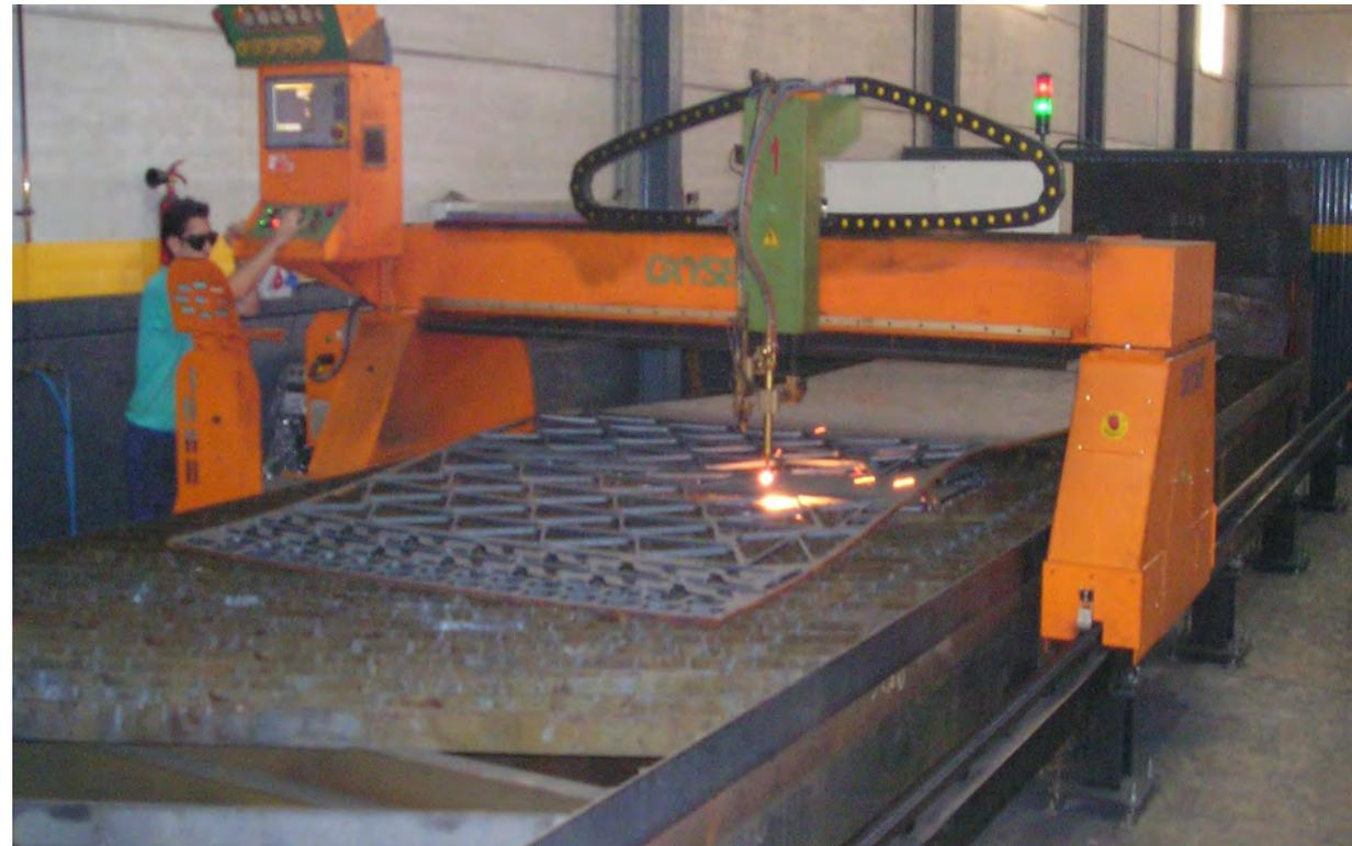
Puente para corte de chapa mediante plasma y oxicorte
