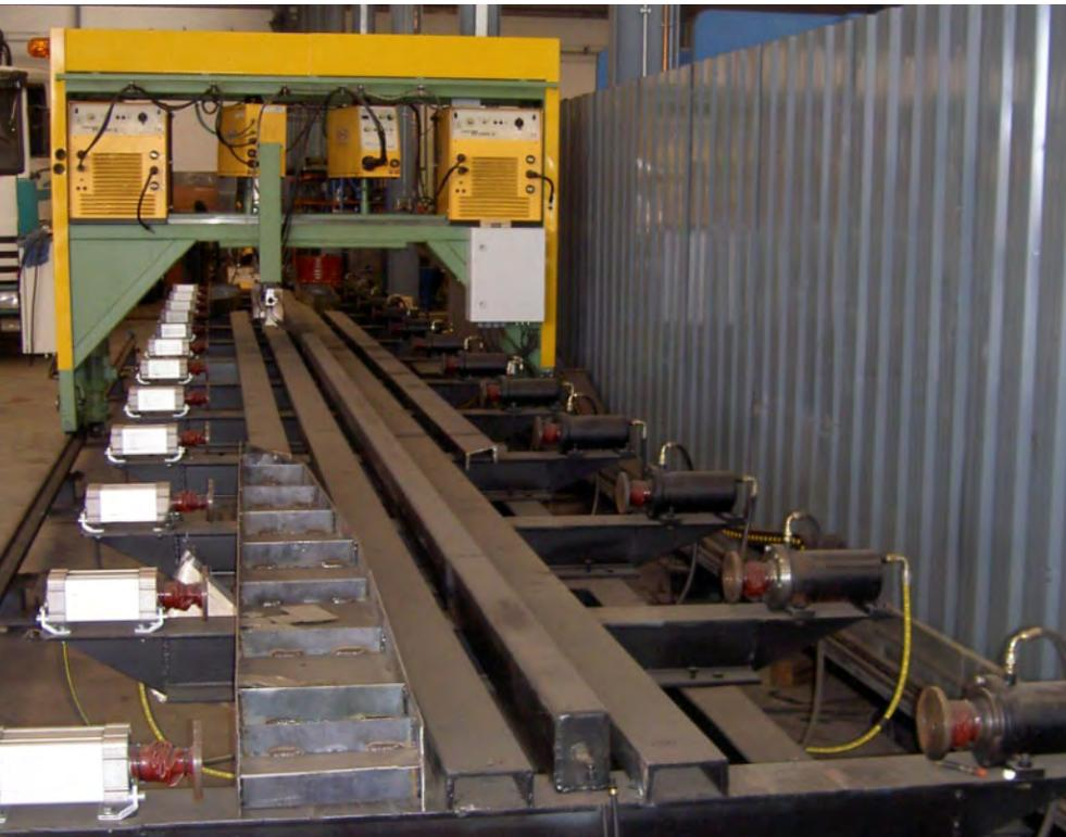
Puente de soldadura para la elaboración de los chasis de los vehículos
