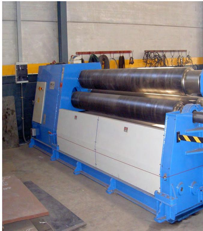
Cilindro de 3 mts para curvado de chapa de acero
