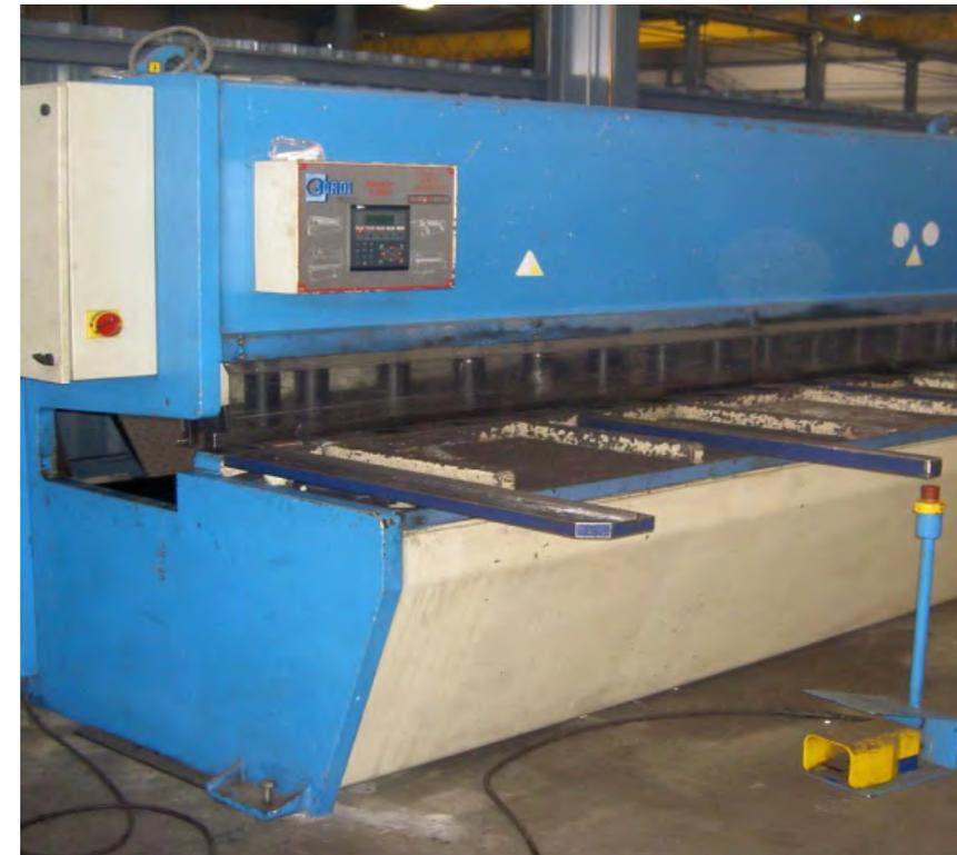
Cizalla para cortes de chapa de 4 mts.
